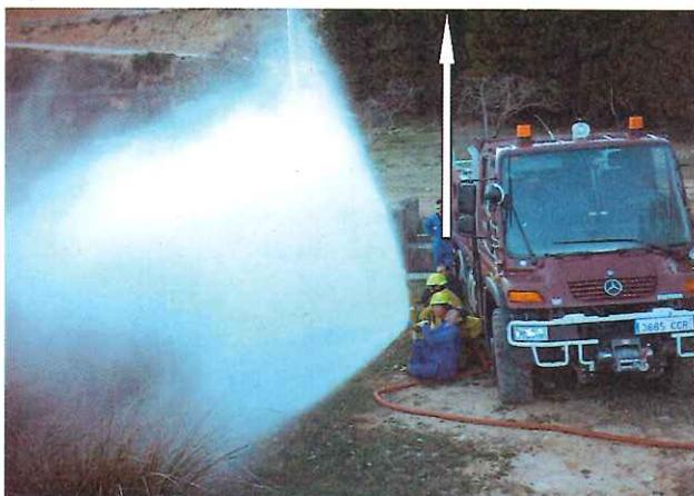
Foto 5. Detalle. Altura y longitud de los conos formados<sup>6</sup>.
