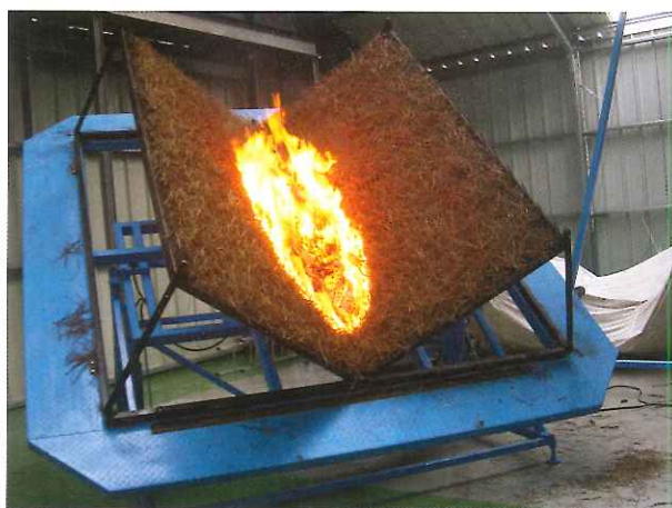
Figura 2 - Estrutura para estudo laboratorial do comportamento eruptivo do fogo existente no Laboratório de Estudos sobre Incêndios Florestais.
