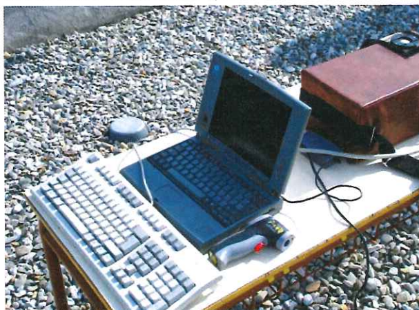
Figura 4. Espectrorradiómetro LICOR LI1800 en el lugar de las medidas.
