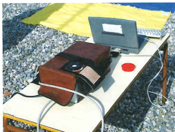
Figura 4-bis. Espectrorradiómetro LICOR LI1800 en el lugar de las medidas.
