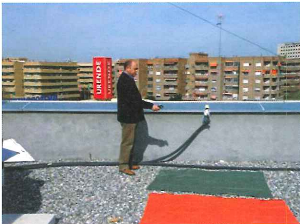
Figura 6. Determinación de la temperatura en la cara expuesta al Sol.
