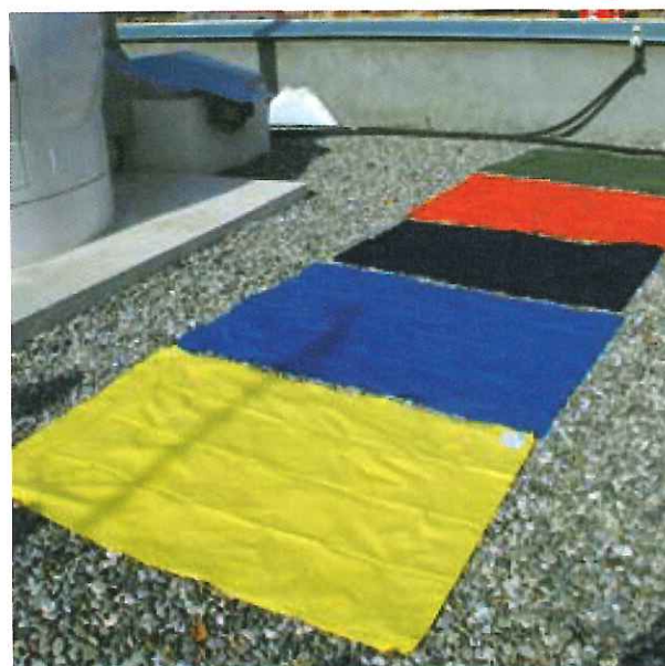
Figura 5. Muestras de tejido en reposo para su aclimatación a las condiciones del entorno.
