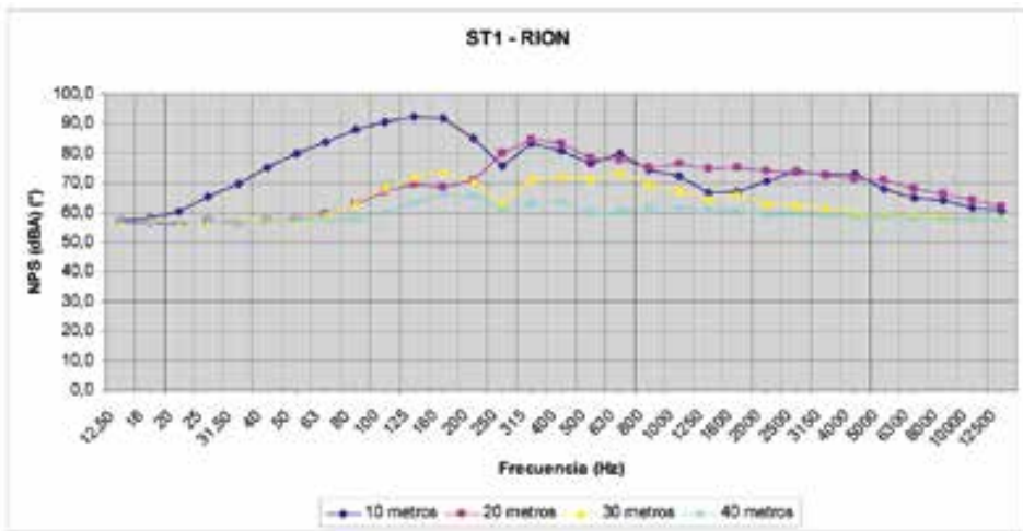
Figura 6: Nivel espectral de presión sonora en función de la distancia. Sonómetro RION, escenario ST1: LLANO(*) las unidades a 10m son dBC; resto dBA
