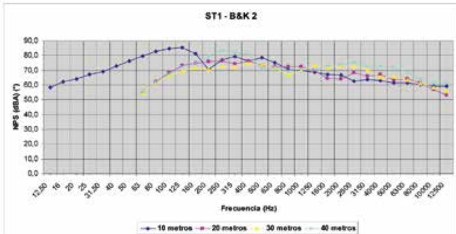
Figura 8: Nivel espectral de presión sonora en función de la distancia. Sonómetro B&K2, escenario ST1: LLANO. (*) las unidades a 10m son dBC; resto dBA
