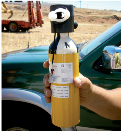
Figura 144 Botella de aire a presión para ser utilizada en situaciones de emergencia. Foto: Justino Sánchez-Sierra Paramio.
