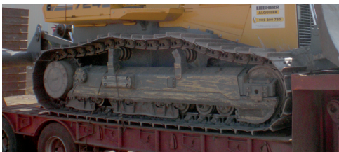
Figura 53 Tipos de trenes de cadenas rígidos, propios de este tipo de tractores. Arriba con rueda motriz trasera, abajo con rueda motriz eleva o rueda cabilla. Izquierda Liebherr PR724. Derecha Caterpillar D6R XL/XLW. Foto: Autor.
