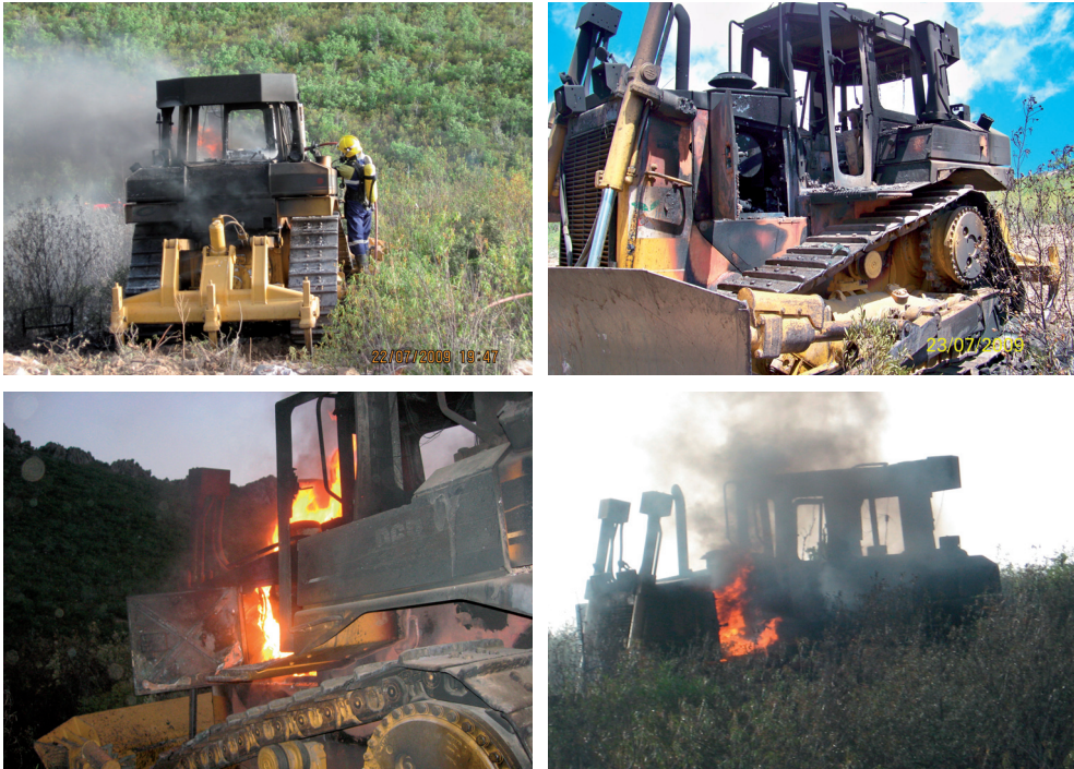
Figura 148 Incendio de un tractor de cadenas mientras participaba en la extinción de un incendio forestal. Incendio San Lorenzo de Calatrava (Ciudad Real). Foto: Justino Sánchez-Sierra Paramio y Juan José Fernández.
