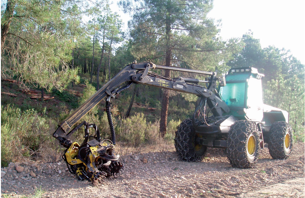
Figura 9 Procesadora sobre tractor forestal de ruedas 4x4. Porzuna (Ciudad Real). Foto: Autor.
