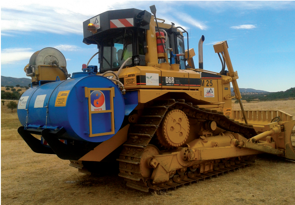
Figura 20 Tractor de cadenas con implemento Aquadozer, provisto de depósito de 1500 l, bomba y dos lanzas fijas. Almadén (Ciudad Real). Foto: Autor.
