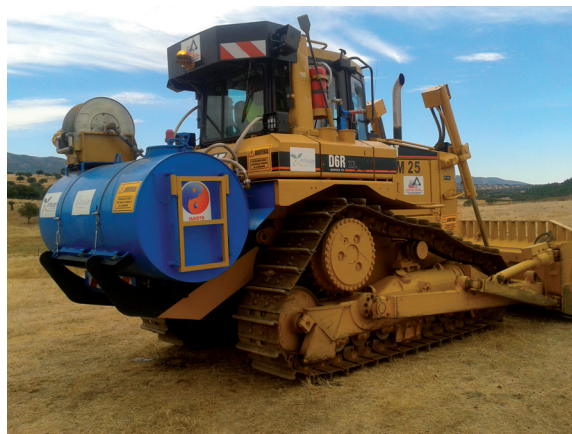
Figura 188 Aspecto del depósito del implemento Aquadozer acoplado sobre una modificación del bastidor de los ripper. Foto: Autor.
