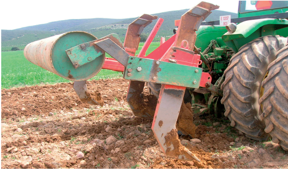
Figura 34 Subsolador de seis brazos (dos elevados) con rulo posterior montado sobre en el enganche tripuntal de un tractor agrícola. Retuerta del Bullaque (Ciudad Real).Foto: Autor.
