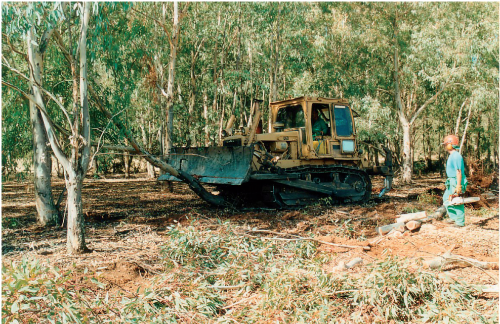
Figura 77 Operación de derribo de eucalipto con tractores de cadenas, levantando la hoja y empujando el tronco del árbol. P.N. Cabañeros, Alcoa de los Montes (Ciudad Real) Foto: Autor.
