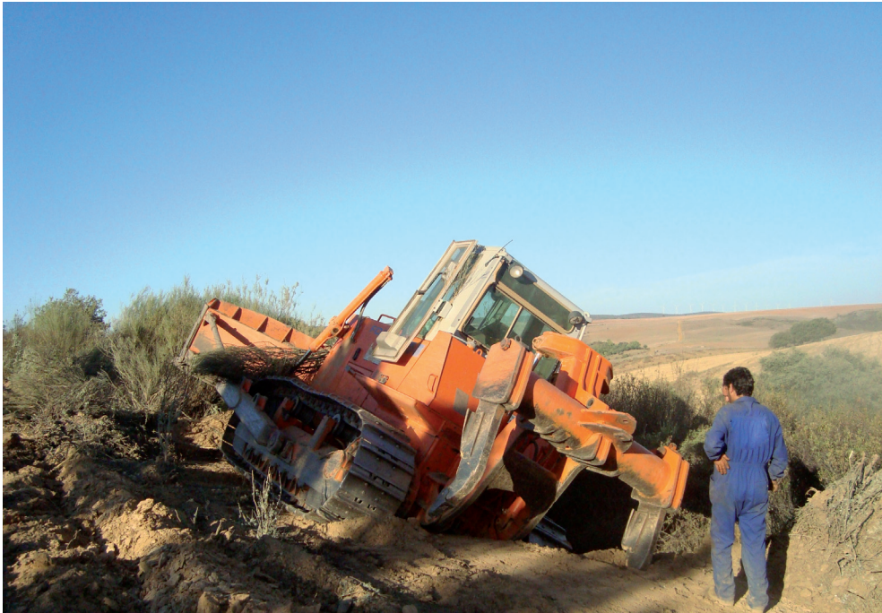
Figura 179 Pérdida de tracción de un tractor en un escalón del terreno. (Zamora). Foto: César Ventosa.
