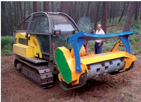
Figura 31 Trituradora de martillos frontal sobre tractor de cadenas UNAC accionada mediante hidráulico. Izquierda Tineo (Asturias) Derecha Montalbán (Teruel).Foto: Autor.
