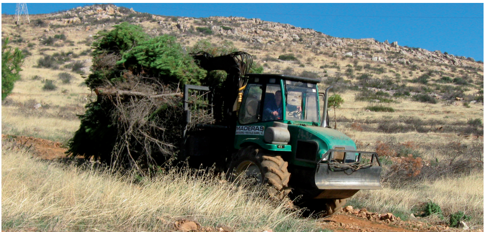
Figura 18 Autocargador transportando árboles enteros. Puertollano (Ciudad Real). Foto: Autor.
