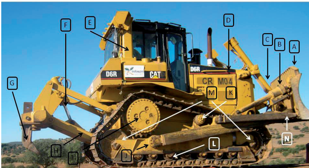
Figura 50 Partes de un tractor de cadenas: A. Hoja de empuje, B. Cilindro del tilt, C. Cilindros de elevación, D. Motor, E. Cabina, F cilindros del subsolador, G Brazo del subsolador, H. Barra, I. Rueda cabilla, J. Bastidor de rodillos, K. Rodillos superiores, L. Rodillos inferiores, M. Rueda guía, N. Brazo de empuje. Foto: Autor.
