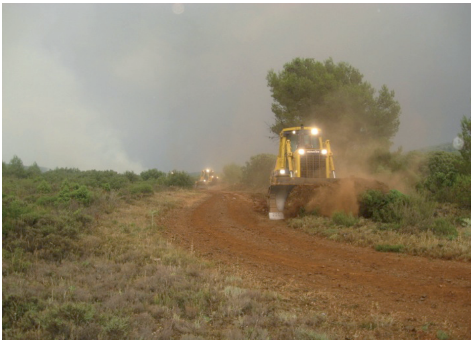
Figura 88 Ataque en paralelo con tractores de cadenas avanzando paralelamente apoyándose en un camino. Cortes de Pallars (Valencia) Foto: Javier García.
