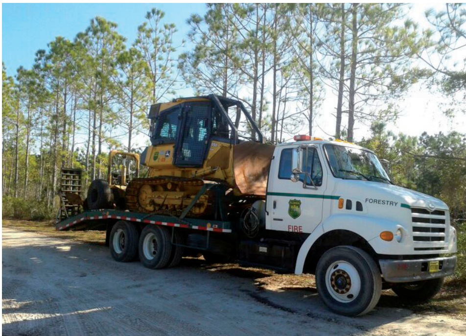
Figura 109 Camión con plataforma para el transporte de maquinaria de menor tonelaje. Florida (USA). Foto: Juan José Fernández.
