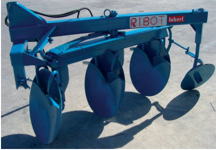
Figura 38 Izquierda arado de disco. Derecha arado de disco trisurco. Foto: www.agromaquiria.es .
