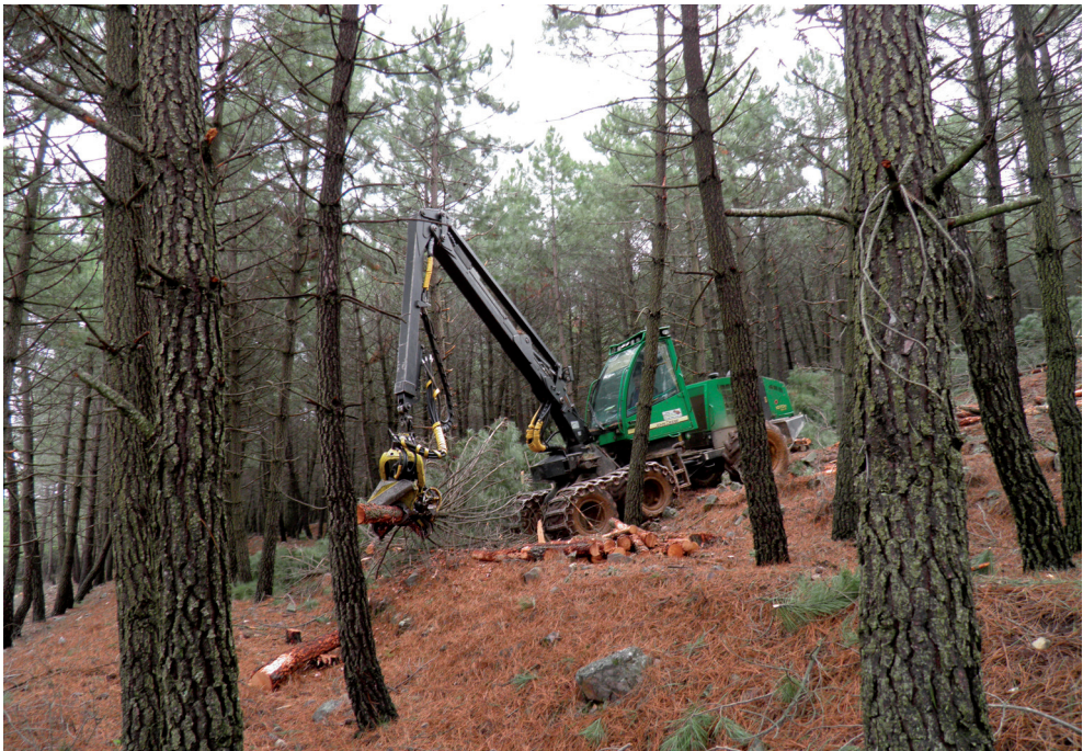
Figura 10 Procesadora sobre tractor de ruedas 6x6 realizando el desrame y tronzado de un árbol en Viso del Marqués (Ciudad Real). Foto: Autor.
