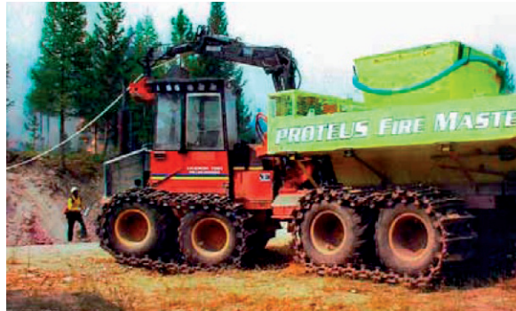
Figura 24 Autocargador con depósito, bomba y boca de carga con helicóptero. Foto: "Yellow book" Mechanized Equipment for Fuel and Fire Operations.2009.
