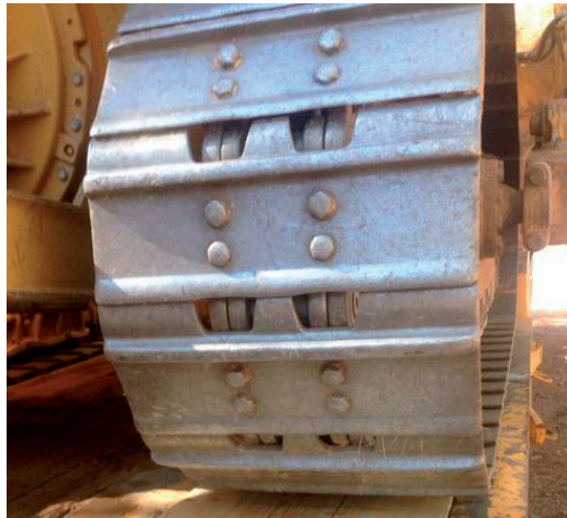
Figura 135 Tejas excesivamente gastadas con riesgo de deslizamiento de la máquina durante la ejecución de los trabajos. Foto: Justino Sánchez-Sierra Paramio.
