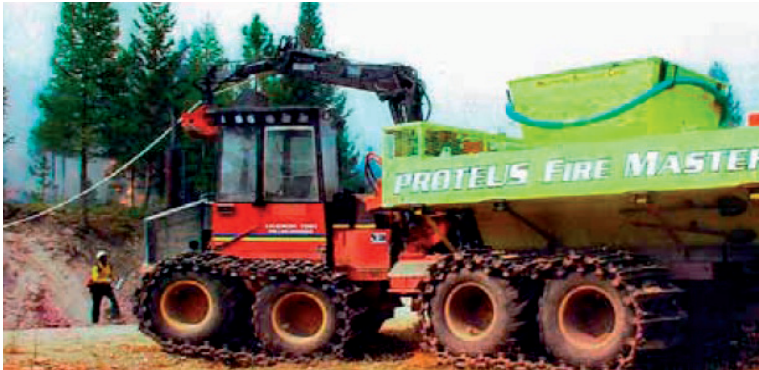
Figura 191 Autocargador con depósito, bomba y boca de carga con helicóptero. Foto: "Yellow book" Mechanized Equipment for Fuel and Fire Operations. 2009.
