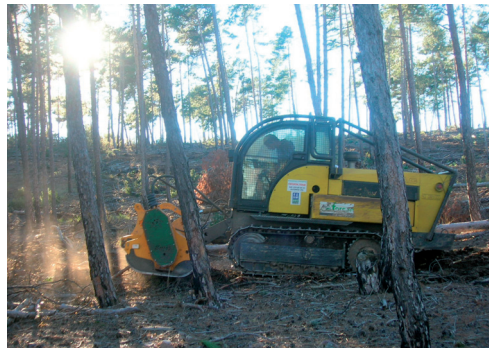
Figura 31 Trituradora de martillos frontal sobre tractor de cadenas UNAC accionada mediante hidráulico. Izquierda Tineo (Asturias) Derecha Montalbán (Teruel).Foto: Autor.
