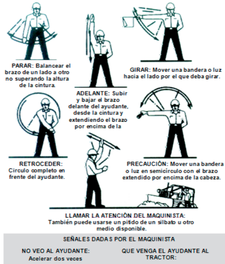
Figura 65 Señalización manual en trabajos con tractores de cadenas. Imagen: Curso para Técnicos de Brigada Helitransportada. DGCONA. MAGRAMA.
