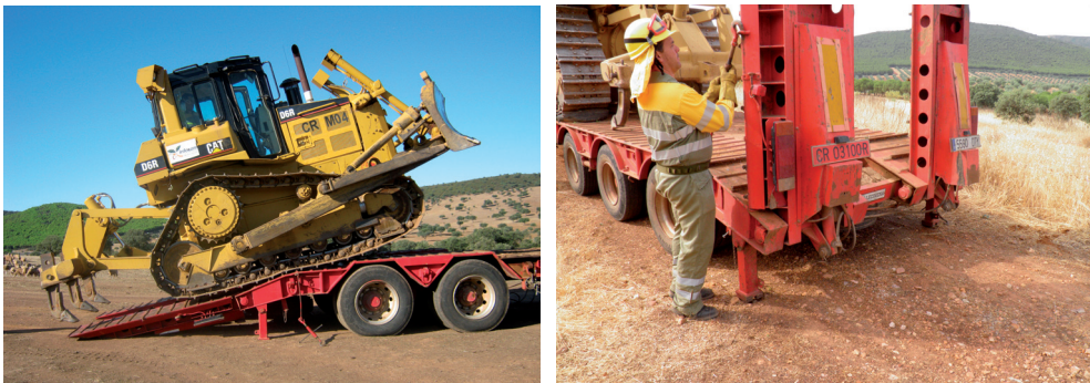
Figura 131 Izquierda Operación de descarga de tractor. Derecha posicionamiento de los pies de apoyo y bajado de las rampas para descarga del tractor. Almadén (Ciudad Real). Foto: Luis Martín.
