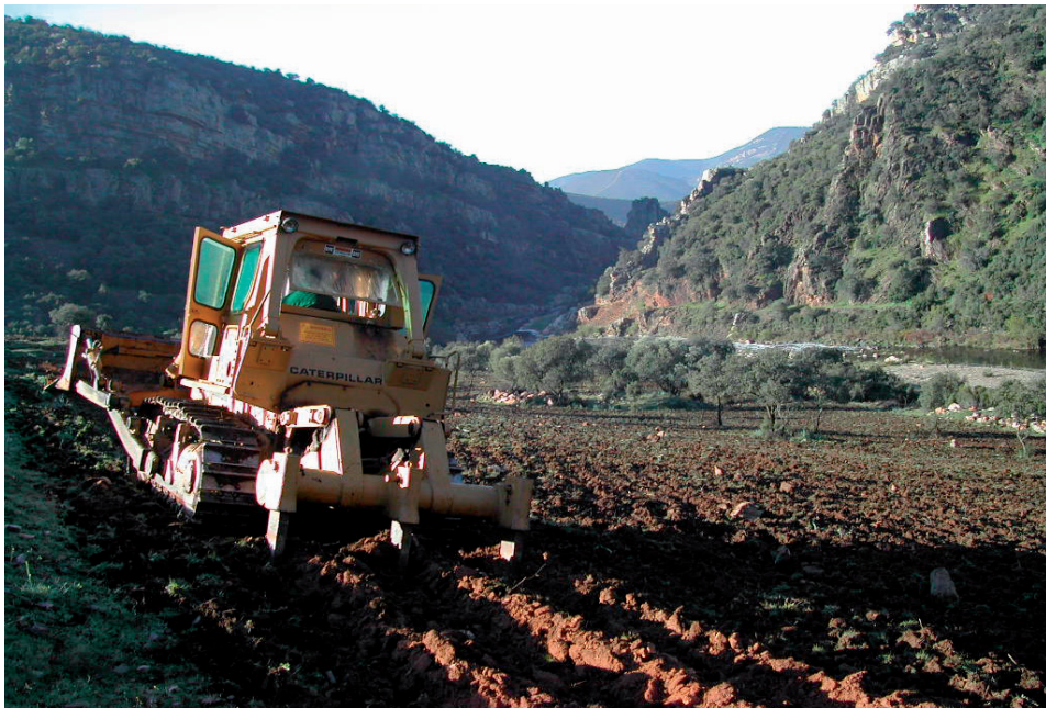
Figura 35 Subsolador de tres brazos sobre tractor de cadenas CAT D7 llevando a cabo preparación de terrenos para repoblación. Mestanza (Ciudad Real). Foto: Autor.
