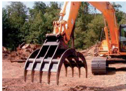
Figura 7 Distintos implementos usados en las retroexcavadoras. Distintas cucharas con grapa o uña, grapa y grapa de matorrales. Fotos: Cardelle.com. Kenco rock solids solutions.
