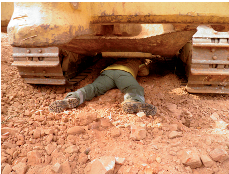
Figura 162 Zona de posible refugio bajo el tractor siendo una de las que puede proporcionar una seguridad adecuada según los tests. Foto: Autor.
