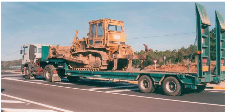
Figura 107 Góndola de dos ejes para transporte de tractor. Góndola demasiado larga para el transporte en incendios forestales. Porzuna (Ciudad Real). Foto: Autor.
