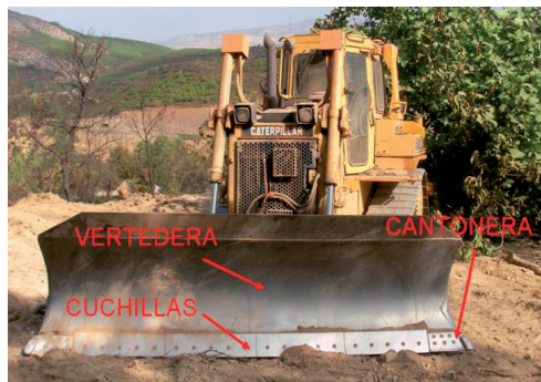
Figura 60 Partes de una hoja de empuje. Vertedera, cuchillas y cantoneras. Foto: Autor.
