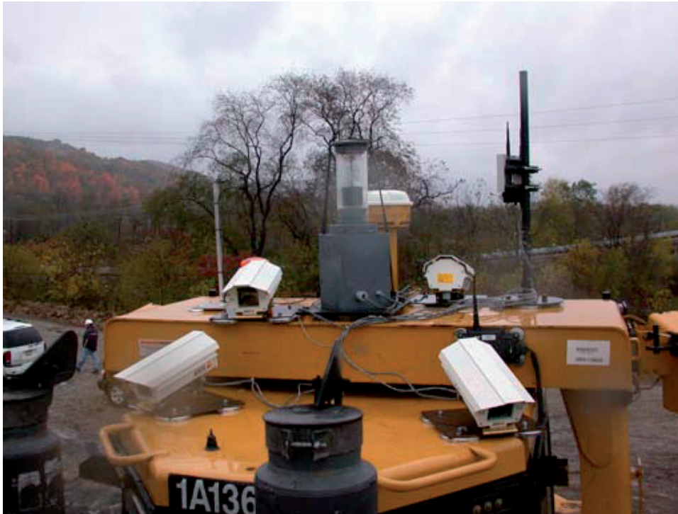
Figura 193 Cámaras digitales sobre la cabina del tractor. Remote vision system for dozer in stockpiles. Foto: William H. Schiffbauer.
