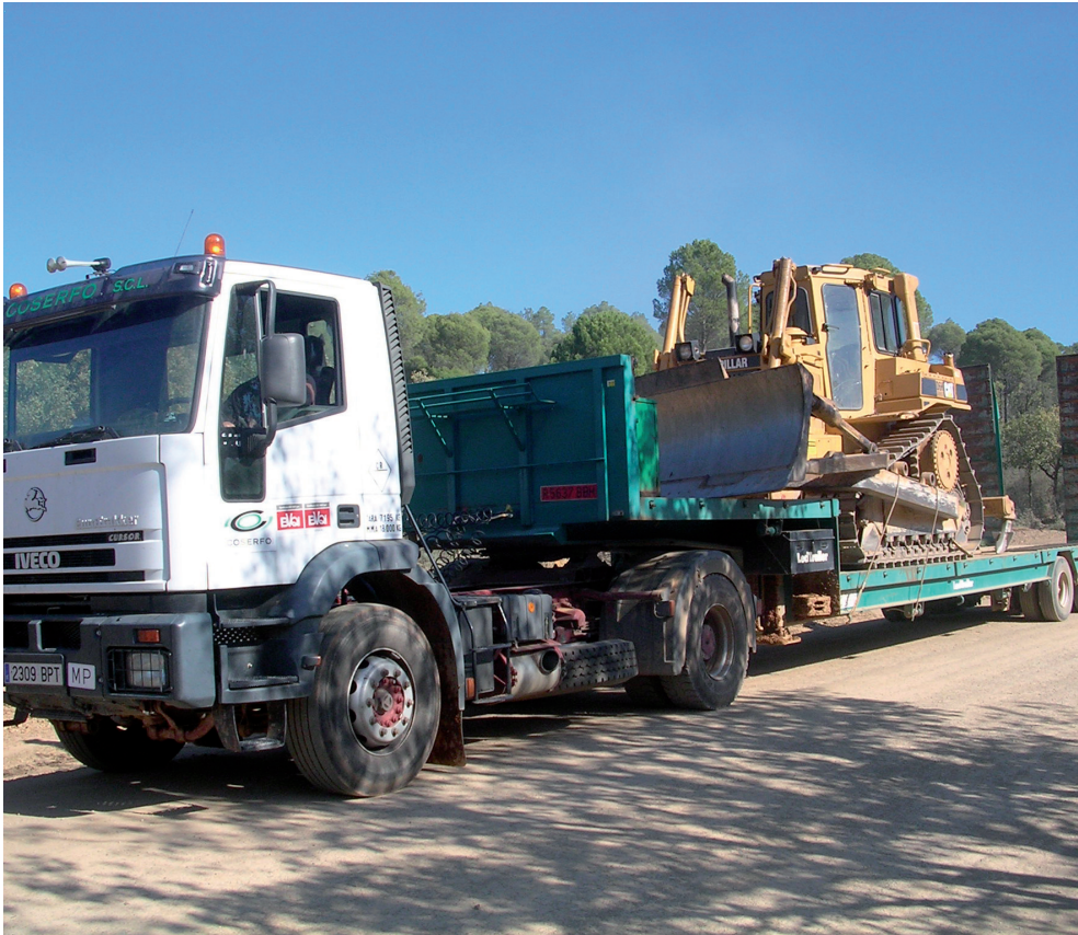
Figura 61 Transporte de equipo de maquinaria pesada constituido por tractor de cadenas y camión-góndola. Observe transporte con hoja de empuje montada y camión-góndola con elevada distancia libre al suelo. Foto: Autor.
