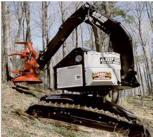
Figura 12 Taladora sobre retroexcavadora hidrostática. Foto: "Yellow book" Mechanized Equipment for Fuel and Fire Operations. 2009.
