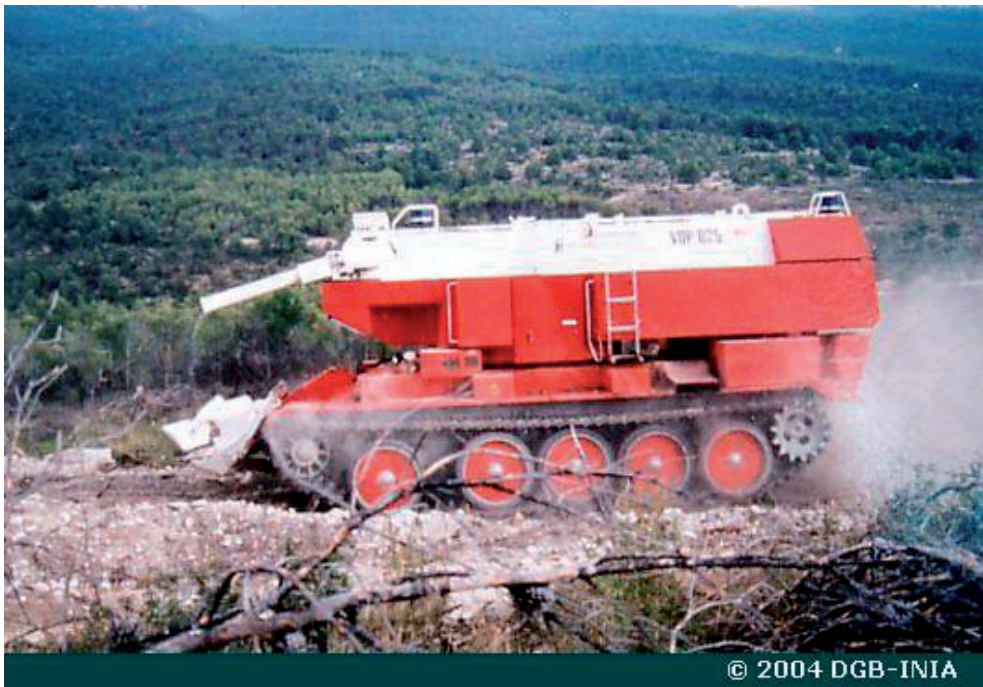
Figura 25 Equipo A.C.R.I.F. (Autobomba sobre cadenas de Refuerzo en la extinción de Incendios Forestales) montado sobre carro de combate soviético T-55 con capacidad de 11.000 l. Carcelén (Albacete) Foto: DGN- COMUNIDAD VALENCIANA. FOTOTECA FORESTAL ESPAÑOLA. DGB-INIA.
