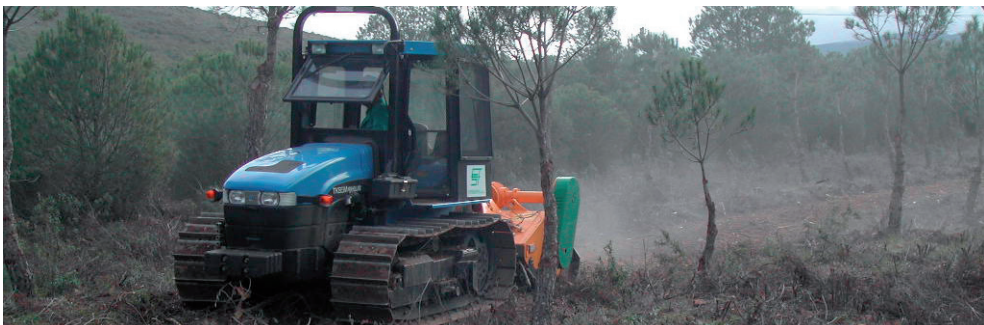
Figura 32 Trituradora de martillos posterior sobre tractor de cadenas con enganche tripuntal y accionada por la toma de fuerza. Puertollano (Ciudad Real) .Foto: Autor.
