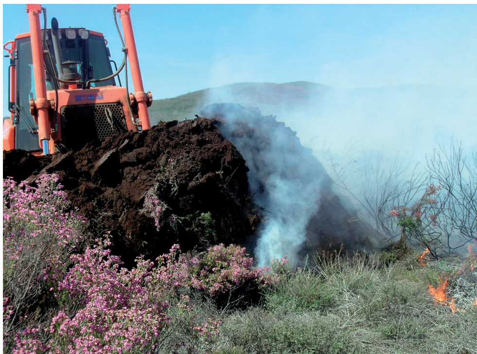
Figura 67 Enterrado del frente y eliminación del comburente en un ataque directo. Rosinos de la Requejada (Zamora). Imagen: Domingo Villalba.
