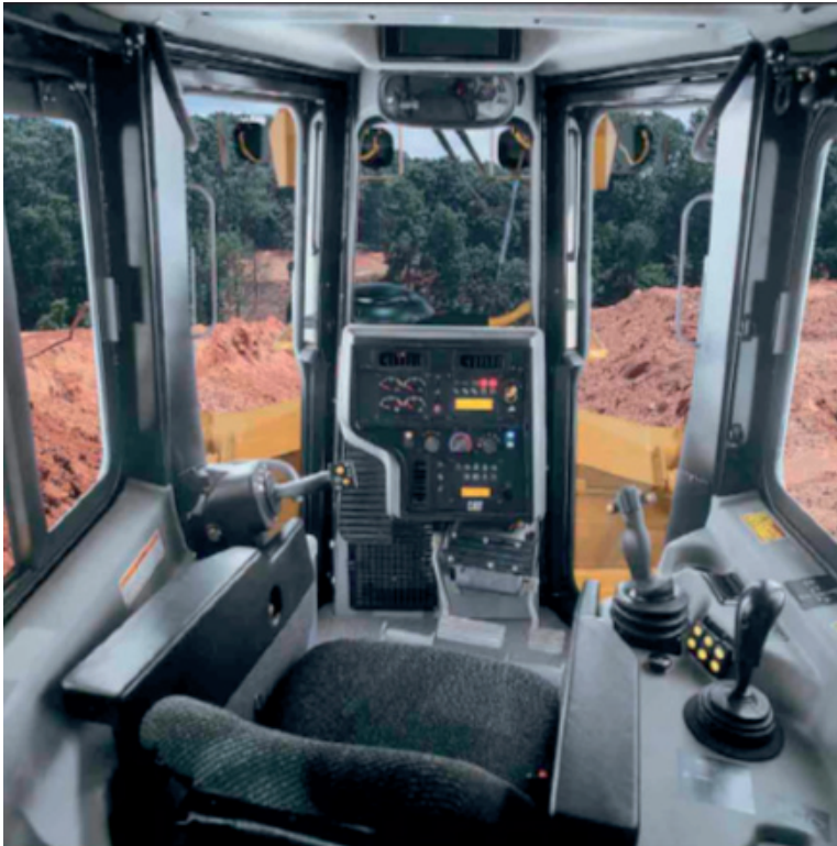
Figura 155 Aspecto del interior de una cabina, de frente panel de control, mando izquierdo de accionamiento del tractor, mando derecho de accionamiento de la hoja de empuje y mando derecho trasero de accionamiento del subsolador. Foto: Manual CAT D6R.
