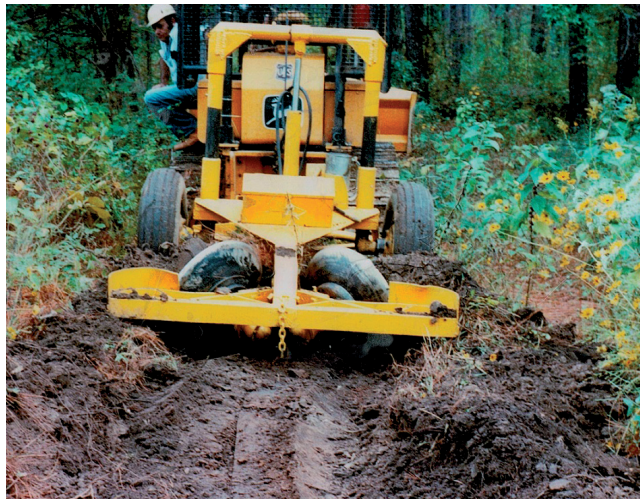
Figura 39 Arados de discos tipo tractor plow. Fotos superiores: Bill Gabbert www.wildfiretoday.com Foto inferior: FESCO, Forestry Equipment Specialist.
