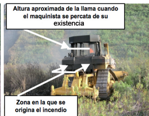
Figura 176 Detalle del inicio del incendio en la máquina y altura a la que llegaba la máquina cuando el conductor se percató de su existencia. Foto: Justino Sánchez-Sierra Paramio
