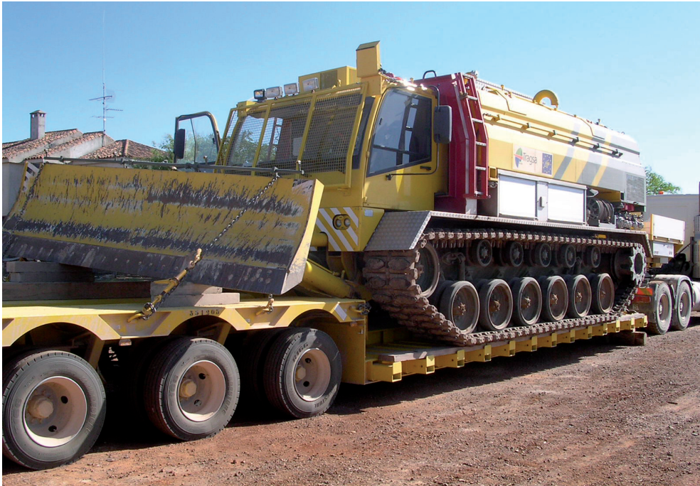
Figura 26 Proyecto VELIF (Vehículo de Refuerzo para la Lucha en la Extinción de Incendios Forestales) montado sobre carro de combate M48 A5E2 y con capacidad de 14.300 l y 500 l de espumógeno. Potencia de 740 C.V. y peso de 62,3 Mg (Tm). Los Yébenes (Toledo). Foto: Autor.
