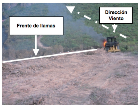
Figura 175 Detalle de la línea de control abierta por la máquina quemada y ubicación de esta en el momento en que el maquinista se percató del inicio del fuego en ella. Foto: Justino Sánchez-Sierra Paramio
