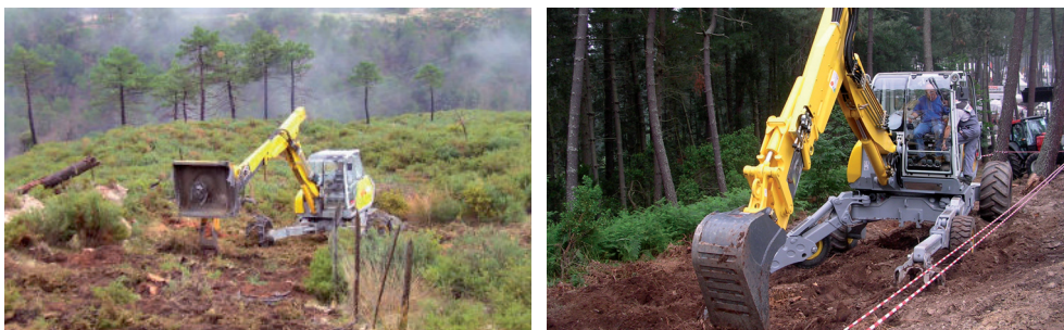
Figura 28 Retroaraña con desbrozadora de cadenas y con cucharón. Tineo (Asturias). Foto: Autor.
