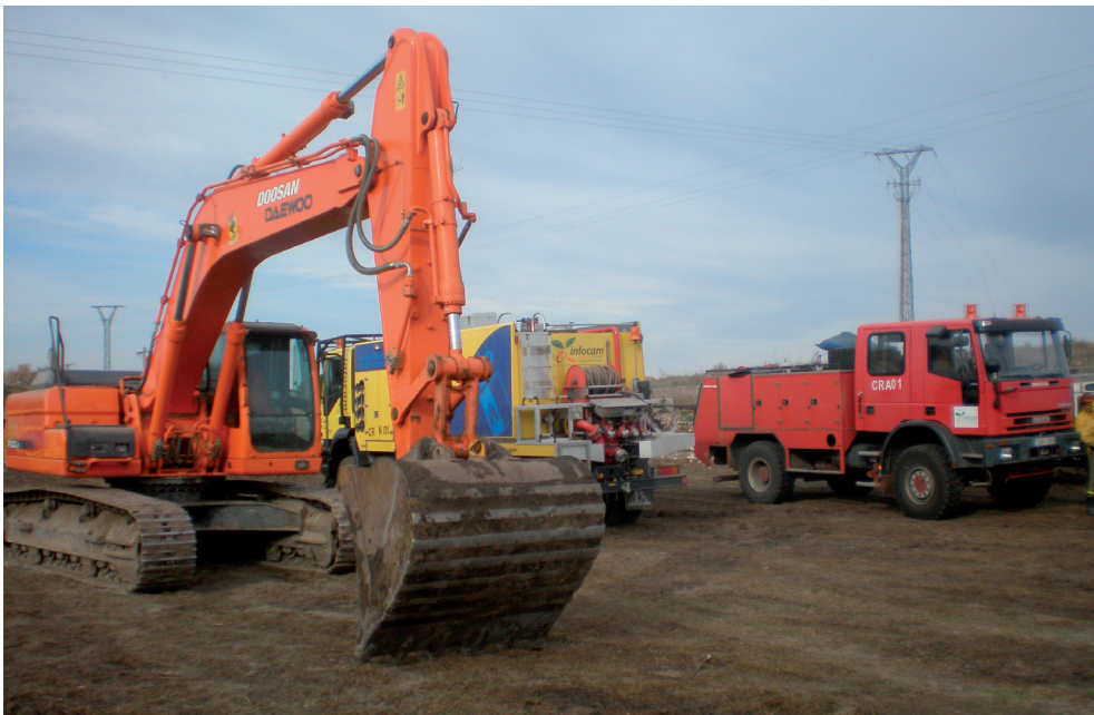
Figura 5 Retroexcavadora en incendio de turberas en el Parque Nacional de las Tablas de Daimiel, usada para hacer una línea de defensa en profundidad. Foto: autor.
