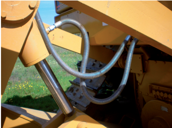
Figura 151 Mangueras del hidráulico del subsolador protegidas con una carcasa metálica. Foto: Autor.
