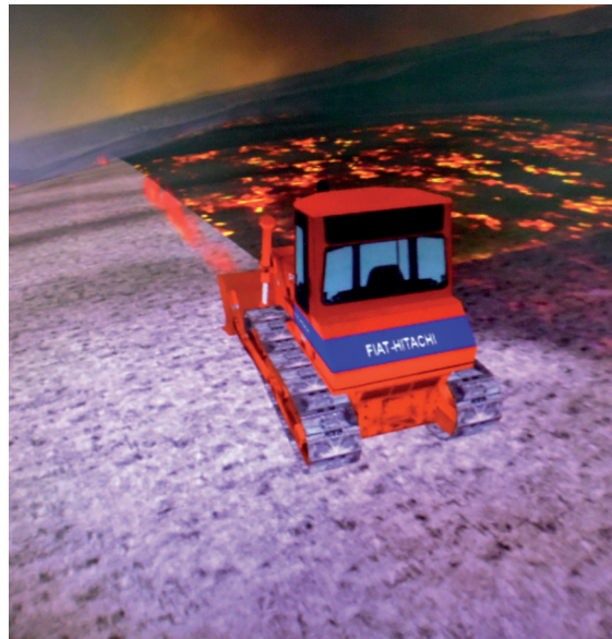
Figura 202 Imagen de un tractor de cadenas en ataque directo en simulador SEILAF. Foto: SEILAF.
