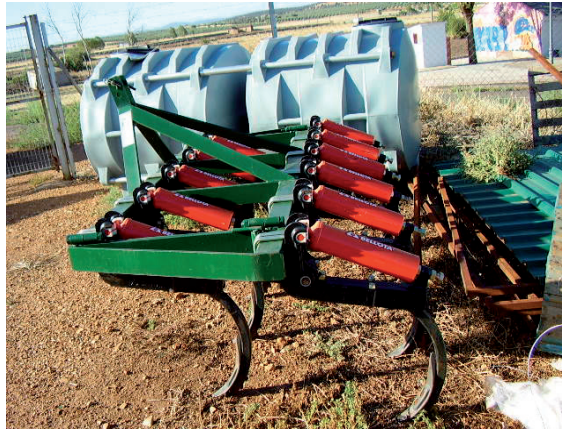
Figura 40 Cultivador de brazos vibrantes con muelles. Foto: Autor.
