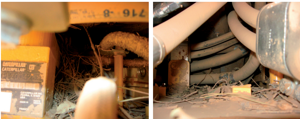
Figura 147 Detalle acumulación broza en bulldozer tras actuaciones en extinción de incendios forestales. Foto: Autor. Justino Sánchez-Sierra Paramio.
