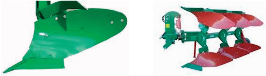
Figura 36 Izquierda partes de un arado de vertedera. Derecha arado de vertedera trisurco reversible. Foto: Agromaquiria.es.
