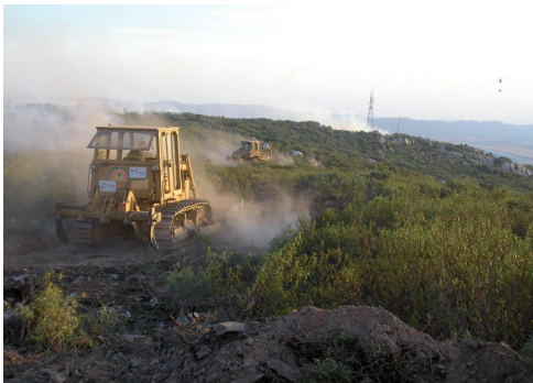
Figura 85 Maniobra combinada de ataque en paralelo en avance continuo con dos tractores y brigadas aplicando fuego técnico. El ataque directo era inviable por la elevada pedregosidad. Puertollano (Ciudad Real) Fotos: Pedro Jareño.
