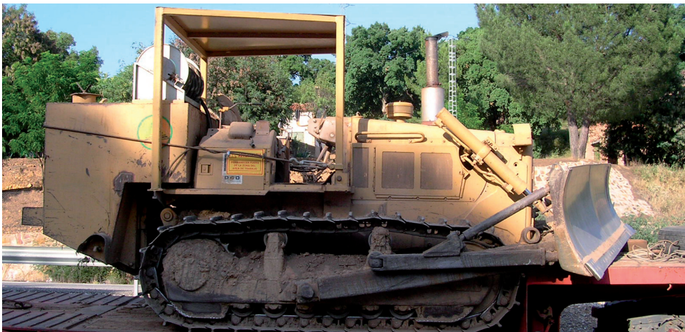
Figura 19 Tractor de cadenas con depósito de agua y bomba. Dicho depósito no disponía de la Certificación o Puesta en Conformidad que establecen las disposiciones mínimas de Seguridad y Salud. Fuencaliente (Ciudad Real). Foto: Autor.
