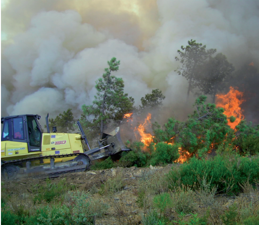
Figura 84 Ataque directo con tractor de cadenas. Nuñomoral (Cáceres) Foto: Juan Jesús Sancho.
