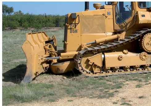
Figura 55 Tipos de hoja de empuje según anclaje. Imagen Izquierda anclaje con arco exterior en CAT D6T. Imagen derecha arco interior en CAT D5H. Fotos: Autor.
