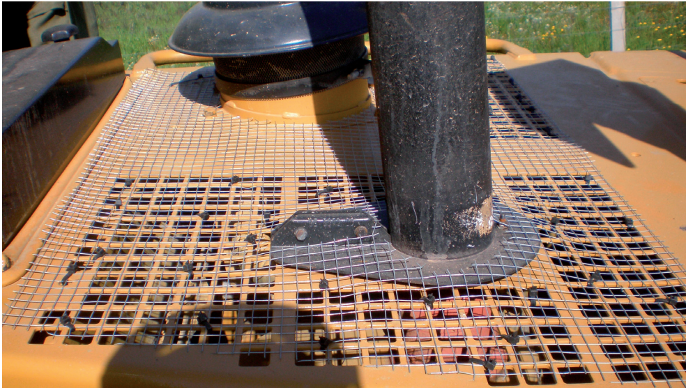
Figura 150 Rejilla metálica instalada para disminuir el calado en la rejilla del motor con objeto de limitar el acceso de material incandescente. Foto: Justino Sánchez-Sierra Paramio.
