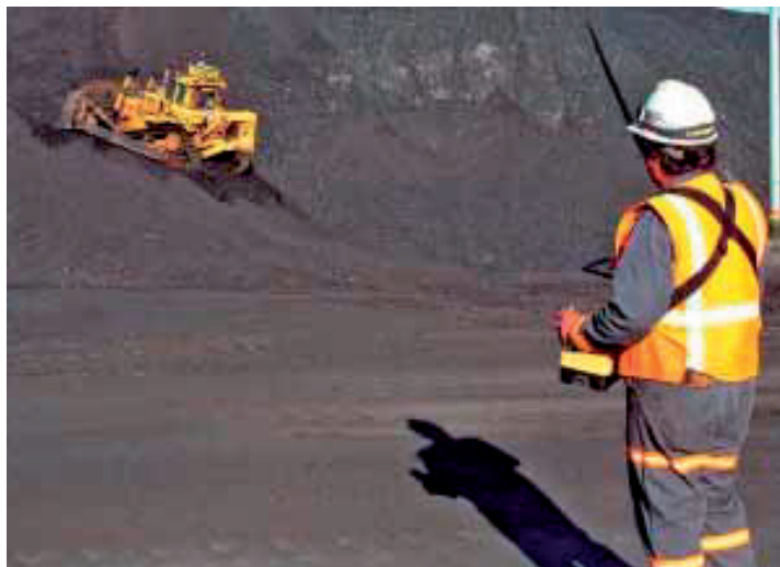
Figura 196 Caterpillar's Integrated Remote Control™ para tractor de cadenas es un sistema de línea de visión directa utilizando comunicación inalámbrica. Foto: Remote Control Technologies.
