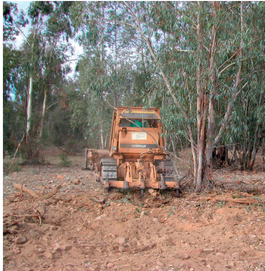
Figura 78 Seccionado de las raíces laterales utilizando los subsoladores del tractor. P.N. Cabañeros, Alcoba de los Montes (Ciudad Real) Foto: Autor.
