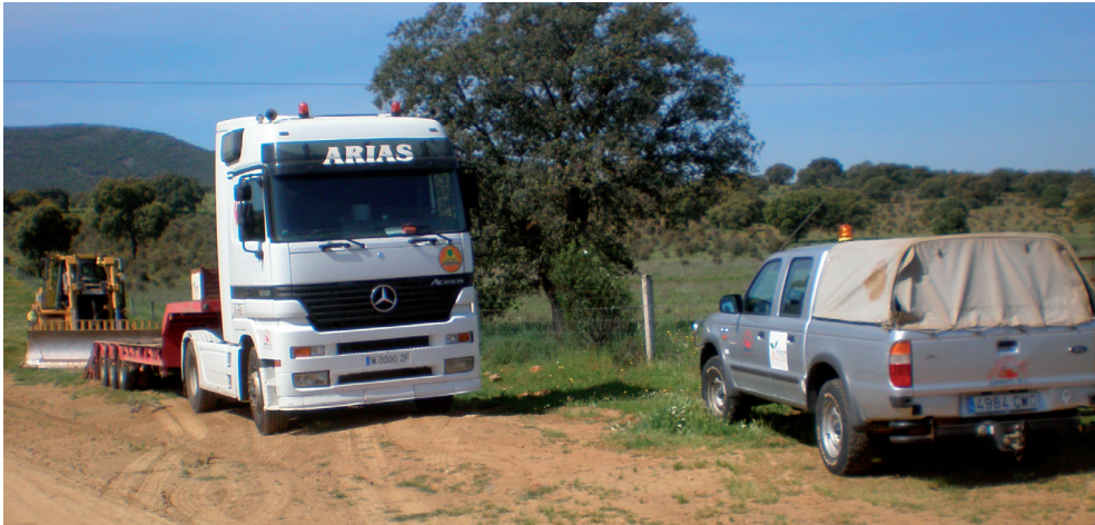
Figura 62 Equipo completo formado por tractor de cadenas, camión góndola y vehículo piloto. El camión góndola no dispone de una altura libre al suelo adecuada. Foto: Autor.
