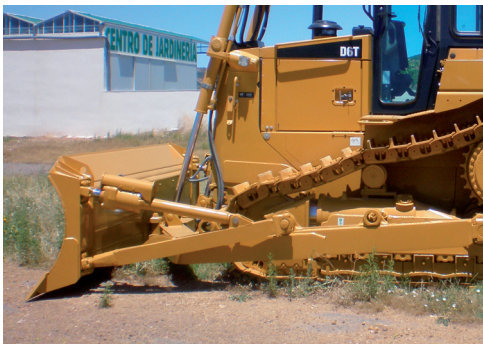
Figura 55 Tipos de hoja de empuje según anclaje. Imagen Izquierda anclaje con arco exterior en CAT D6T. Imagen derecha arco interior en CAT D5H. Fotos: Autor.
