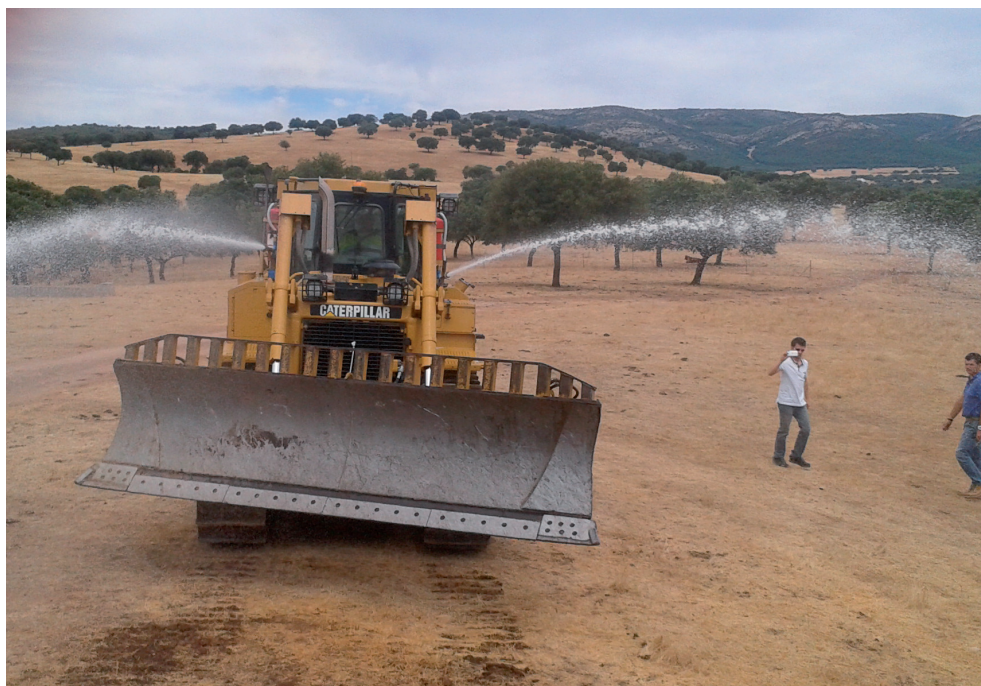
Figura 189 Aplicación de agua desde la punta de lanza fija lateral. Foto: Autor.
