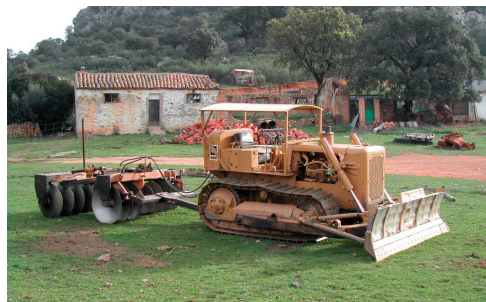
Figura 43 Grada de discos de dos cuerpos arrastrada por tractor de cadenas con discos lisos. Andújar (Jaén). Foto: Autor.
