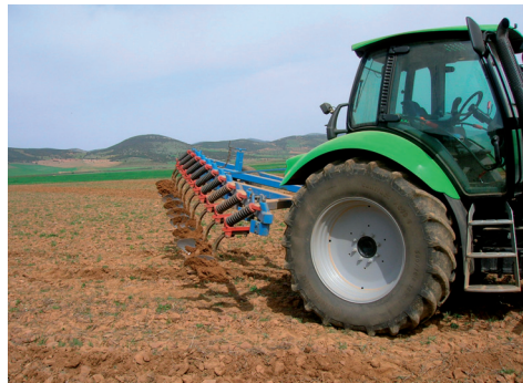
Figura 37 Izquierda prisma de tierra volteado por las vertederas. Derecha arado de vertedera polisurco. Foto: Autor.
