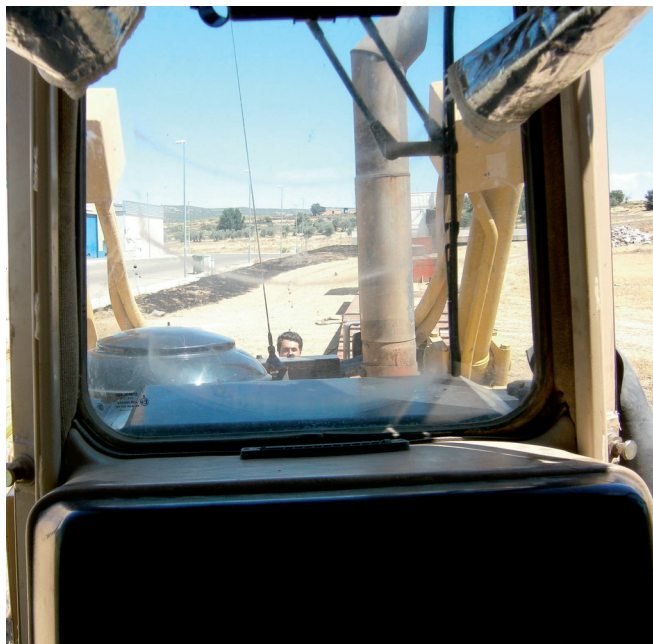
Figura 139 El conductor del bulldozer vería la cabeza a una persona de aproximadamente 1,70 m. de altura cuando ésta se sitúa a una distancia de aproximadamente 5 metros de la máquina de frente al puesto de conducción Foto: Justino Sánchez-Sierra Paramio.
