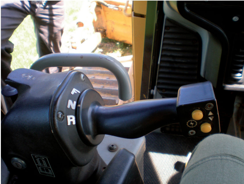
Figura 52 Palanca de accionamiento de tractor de cadenas: F: marcha adelante, R marcha atrás. Botones amarillos para realizar el cambio de velocidades. Caterpillar D6R. Foto: Autor.
