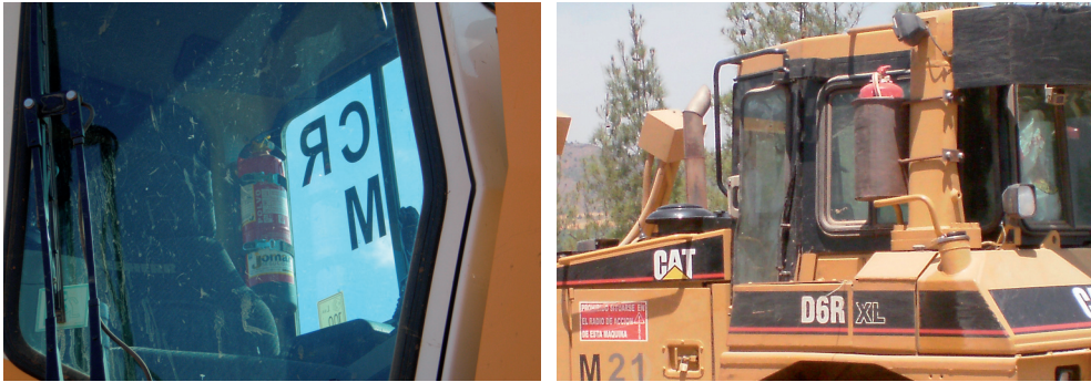
Figura 146 Izquierda extintor en el interior de la cabina. Derecha extintor en el exterior. Foto: Autor.
