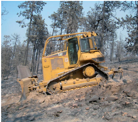
Figura 186 Aspecto de la máquina tras el paso del fuego. Puede observarse los pocos daños sufridos. Poco Fire (Arizona). Foto: Poco Fire Incident Analysis Report. Northern Arizona Incident Management Team.
