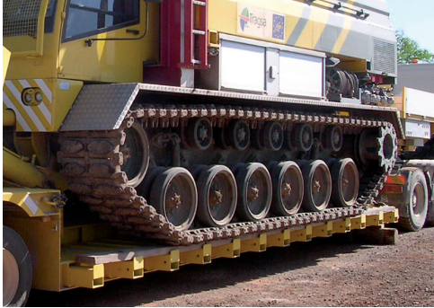
Figura 54 Tipos de trenes de cadenas flexibles donde los rodillos inferiores pueden presentar cierta movilidad adaptándose al terreno. Izquierda Proyecto VELIF. Foto: Autor.
