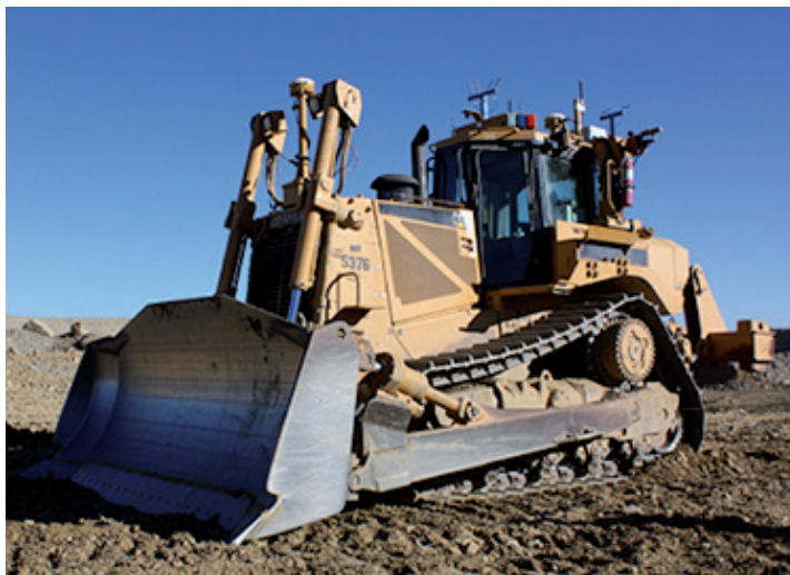
Figura 192 Cámaras y GPS montados sobre tractor de cadenas para control remoto. Foto: Remote Control Technologies.
