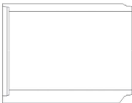
Corte longitudinal tubo de base plana
