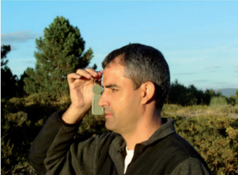
Posicionamiento correcto del clisímetro para realizar una medición.
