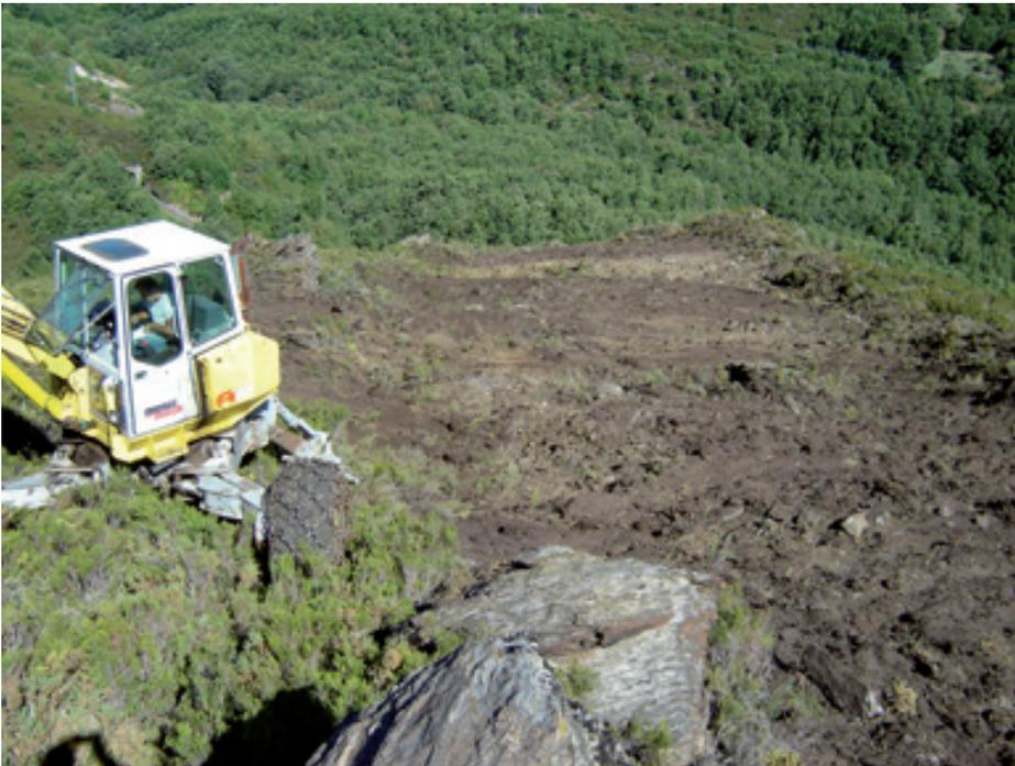
Apertura de cortafuegos con retroaraña y cazo de excavación.
