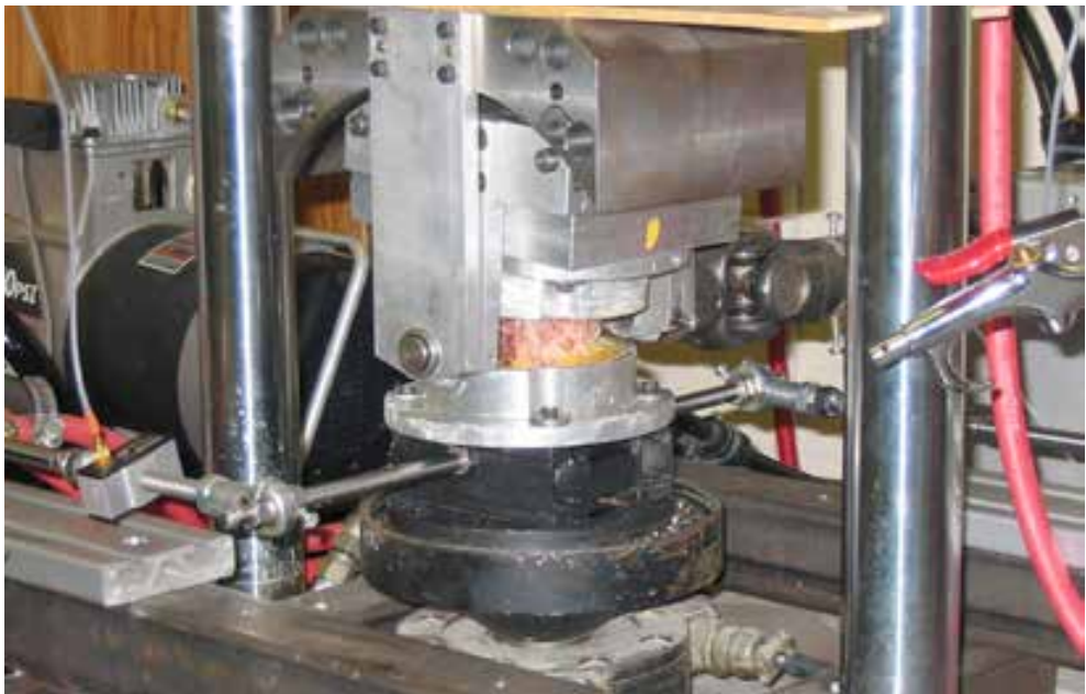
Figura 53. Fotografía del equipo de carga de la columna vertebral en flexión, extensión, compresión y torsión axial. Ver Bibliografía gráfica
